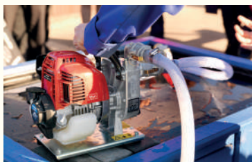
Из-за малой массы (от 6,1 кг) насосы серии WX удобно переносить
