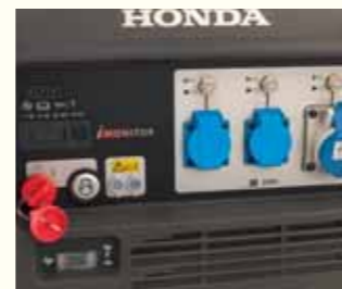
Нажмите на кнопку, чтобы запустить двигатель
