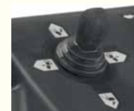
Управление желобом с помощью джойстика
